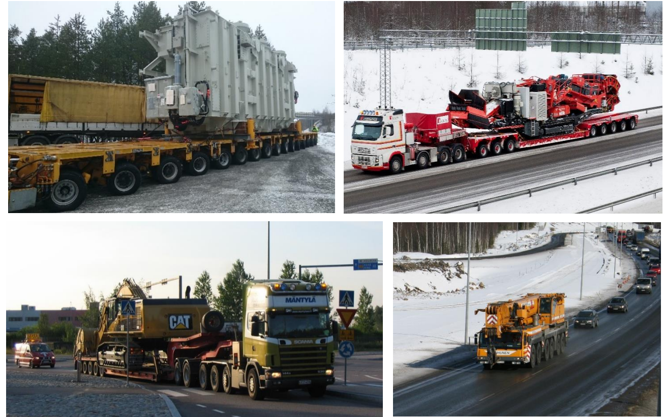
Kuvat 6–9: Tuulivoimarakentamiseen liittyviä erikoiskuljetuksia: suurmuuntajakuljetus (Lauri Savolainen 2016), murskainten kuljetus (Kuljetusliike Matti Janhunen 2016), työkoneen kuljetus (Juha Savolainen 2016) ja ajoneuvonosturi (Kuljetusliike Matti Janhunen 2014).
