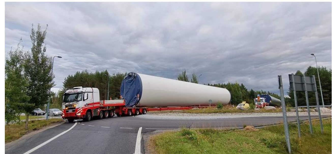
Kuva 12: Tornilohkon erikoiskuljetus (Vuorsola 2022)
