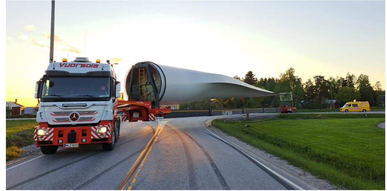
Kuva 11: Tuulivoimalan lavan erikoiskuljetus (Vuorsola 2022)
