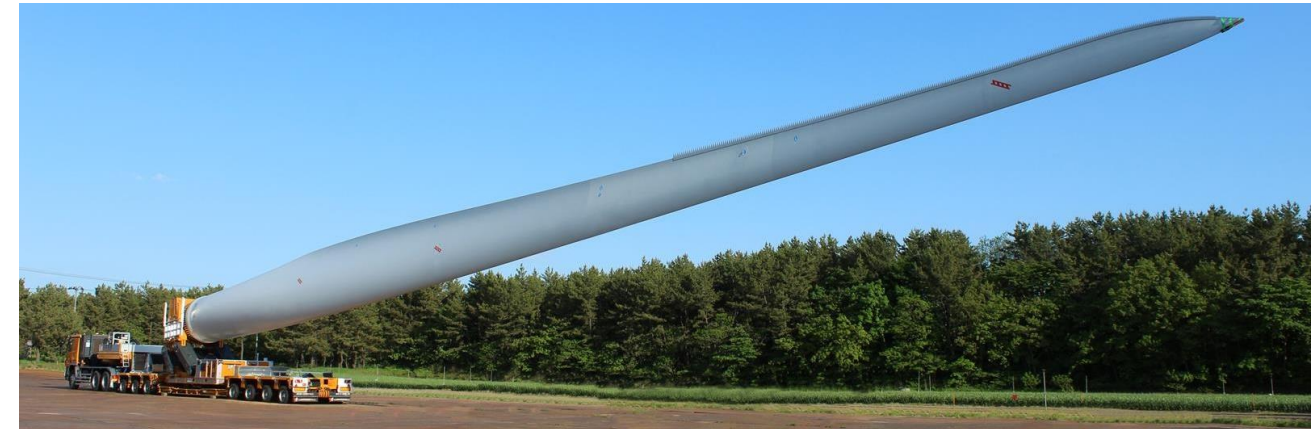
Kuva 17: Faymonvillen valmistama BladeMAX bladelifter -perävaunu (Faymonville 2022)
