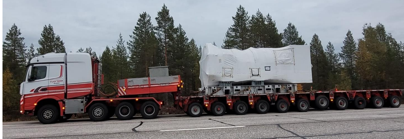
Kuvat 13–14: Konehuoneen osien erikoiskuljetuksia (Trygve – stock.adobe.com ja Vuorsola 2022)
