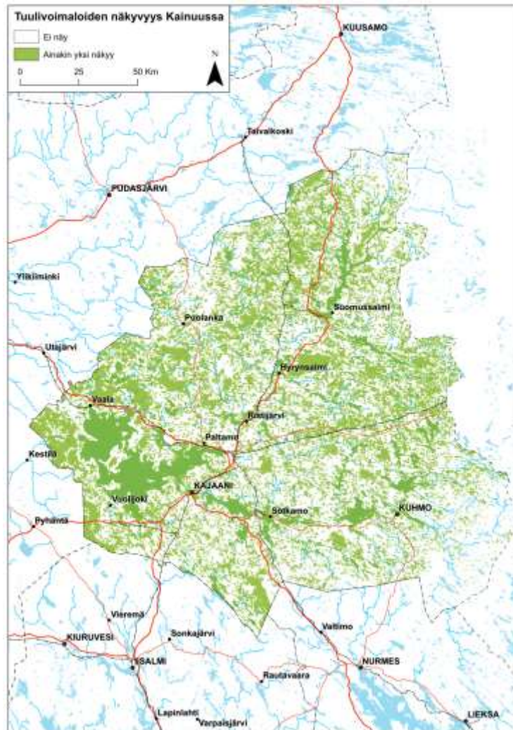
Kuva 3.7. Tuulivoimaloiden näkyvyys napakorkeudeltaan 140 m voimaloille, joita on sijoitettu kaikille tuulivoiman tarkastelualueille. Kuva: ESRI Finland Oy
